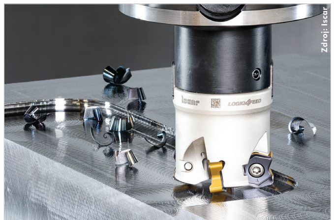
Obr. 3. Fréza z řady Logiq-4-Feed s vyměnitelnými destičkami se specifickým tvarem (ve tvaru kosti) rozšiřuje možnosti frézování s vysokým posuvem (HFM) při obrábění forem a zápustek.
