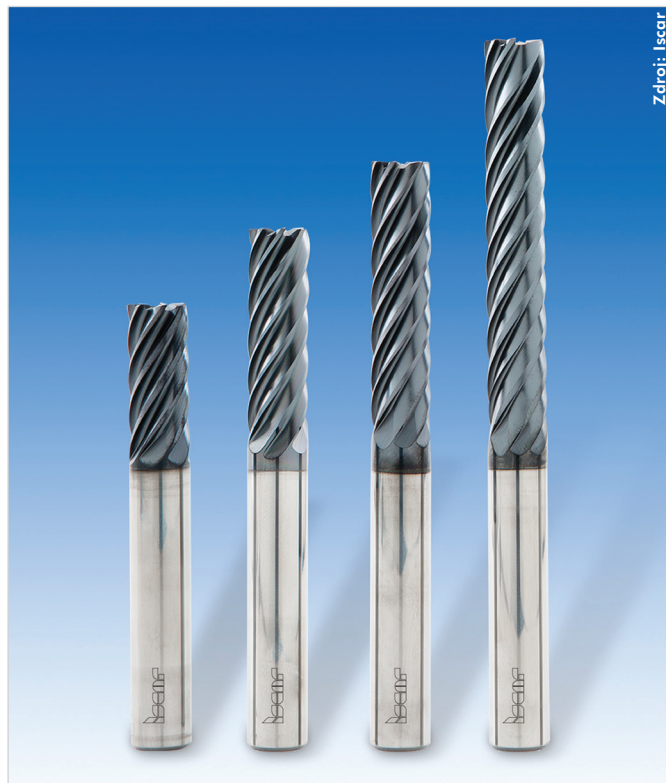
Obr. 1. Sedmibřité monolitní frézy EC-E7/H7-CF z řady Chatterfree s nepravidelnou zubovou roztečí a různým úhlem stoupání šroubovice.
