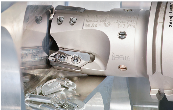
Obr. 2. Čelní fréza HSM90S FAL-22 z řady Helialu slouží k obrábění hliníku při extrémně vysokých řezných rychlostech. Lůžko destičky je speciálně konstruováno tak, aby byl eliminován radiální posun břitové destičky, ke kterému může dojít v důsledku vysokých odstředivých sil.
